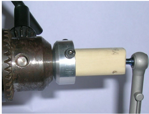
FIG. 3.5 Mandril do torquímetro, dispositivo de acoplamento, cilindro de poliuretano, montador e catraca manual durante uso
