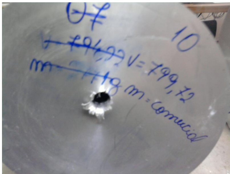
FIG. 3.10 Formação semelhante à pétala na face impactada do alvo.
