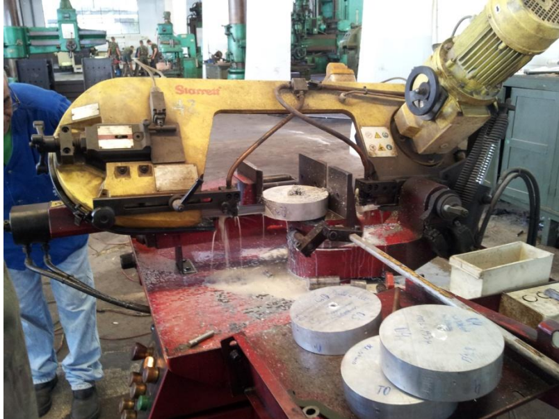
FIG. 3.9 Máquina de serra de fita horizontal semiautomática Starret St – 4002 utilizada no AGR para realização dos cortes.
