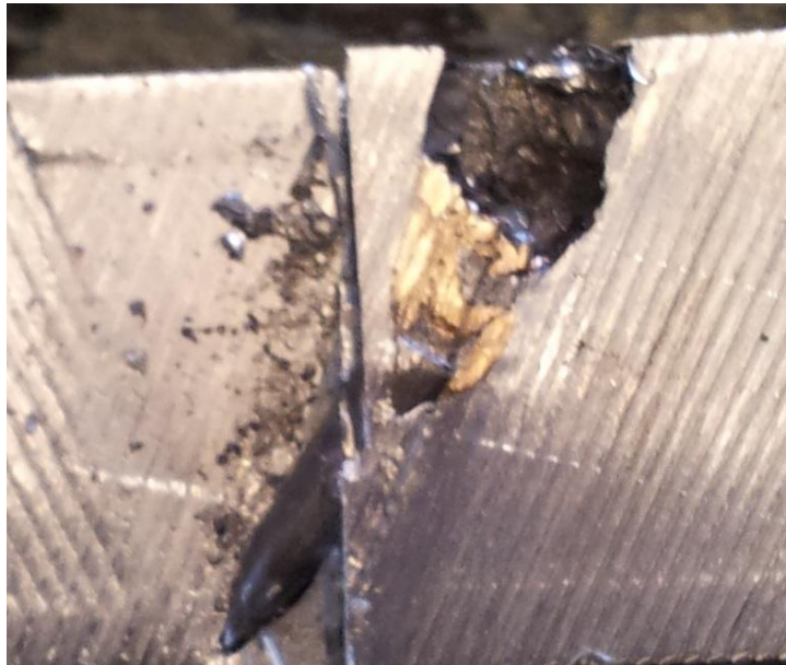
FIG. 4.19 Jaqueta do projétil após penetração no alvo.
