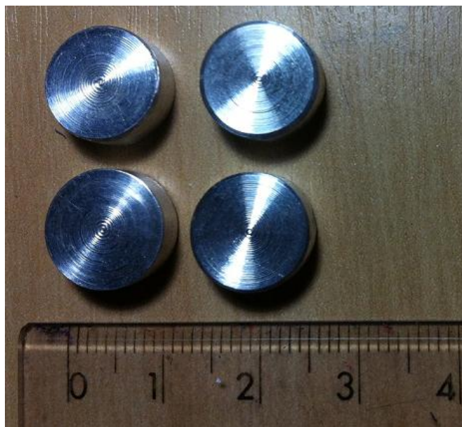
FIG. 3.8 Corpos de prova utilizados na Barra Hopkinson.
