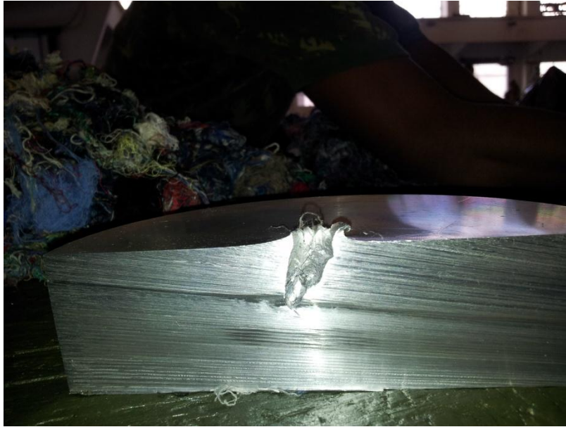
FIG. 3.11 Trajetória do projétil no interior do alvo.
