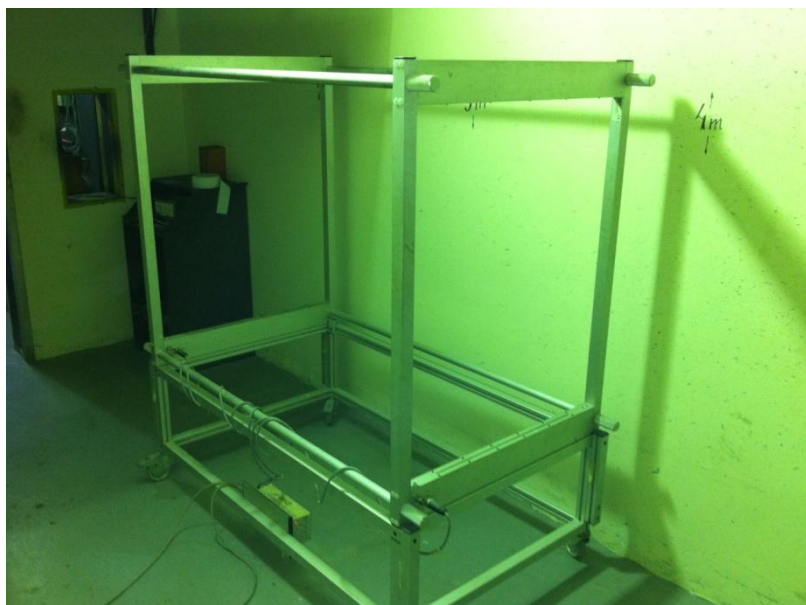
FIG. 3.5 Barreira óptica B471 Precision Light Screen (HPI – High Pressure Instrumentation) com o registrador de tempo, a pequena caixa localizada na parte inferior da barreira.
